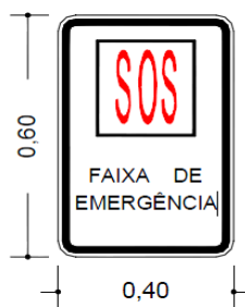
Figura 6 Placa para sinalizar as rotas de emergência.
