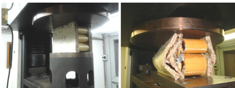
**Figura 2-Ensaio de compressão do painel sanduíche de bambu**
