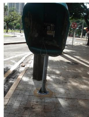
**Figura 16 - Obstáculos suspensos sem sinalização de alerta - em frente à Câmara de Maringá**
